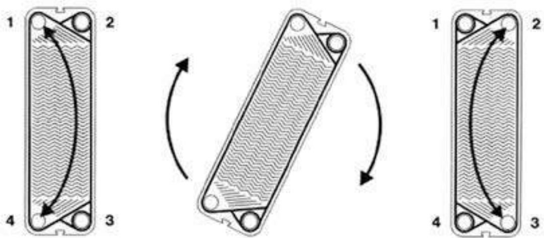
Рисунок В.4 – Схема преобразования левой пластины L в правую пластину R для их компоновки и правильной сборки
