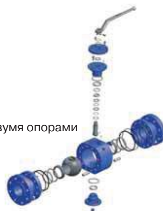
Конструкция крана с двумя опорами шара
